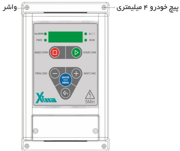
شکل 4 نمایش نصب دستگاه به صورت تراز با سطح افق
